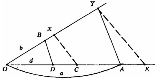
Даны пять отрезков:  $a, b, c, d, e$ . Необходимо построить отрезок  $x = \frac{abc}{de}$ . Построим сначала отрезок данной  $y = \frac{ab}{d}$ , а затем искомым отрезок  $x = \frac{abc}{de}$ .
