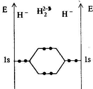
На связывающей MO находятся два электрона и на антисвязывающей MO – два электрона, они компенсируют друг друга. Молекулярный ион  $H_2^{2-}$  существовать не может.
