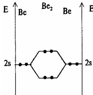
На связывающей MO находятся два электрона, а на антисвязывающей MO тоже два электрона, их действие компенсируется, значит молекула  $\text{Be}_2$  не существует.
